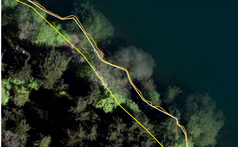
Abbildung 3: Im Waldbereich war für die Festlegung der Uferlinie vor allem die modellierte Hochwasserlinie (orange Linie) massgebend, da aufgrund der überhängenden Bäume die Abgrenzung See-Land in den Orthophotos schwierig zu erkennen ist und die Schrägluftbilder nur teilweise helfen.
