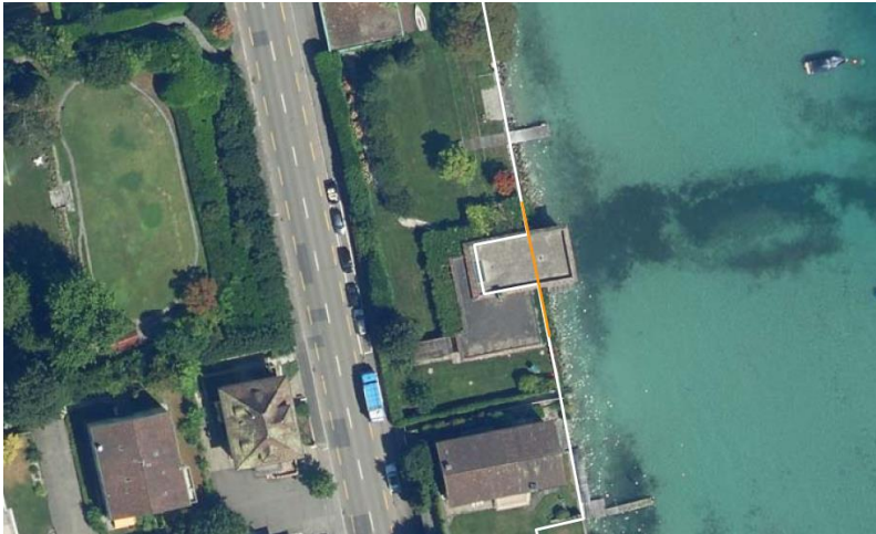
Abbildung 7: Bei Bootshäusern, welche sich halb im Uferbereich befinden und halb in den See ragen, wird die Uferlinie im generellen Trend des Seeufers geführt (orange Linie).
