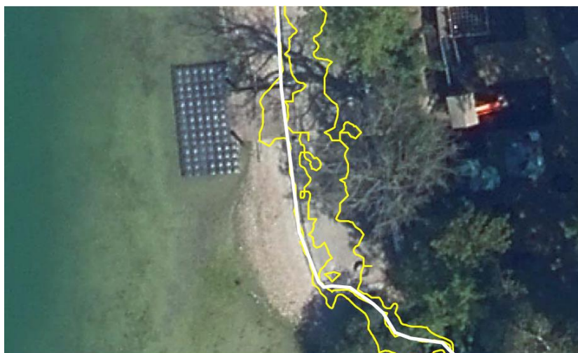
Abbildung 2: Bei befestigten Steilufern (Mauer in diesem Beispiel) wurde die Uferlinie der AV übernommen (weiss) und folgte nicht der Modellierung (gelb).
