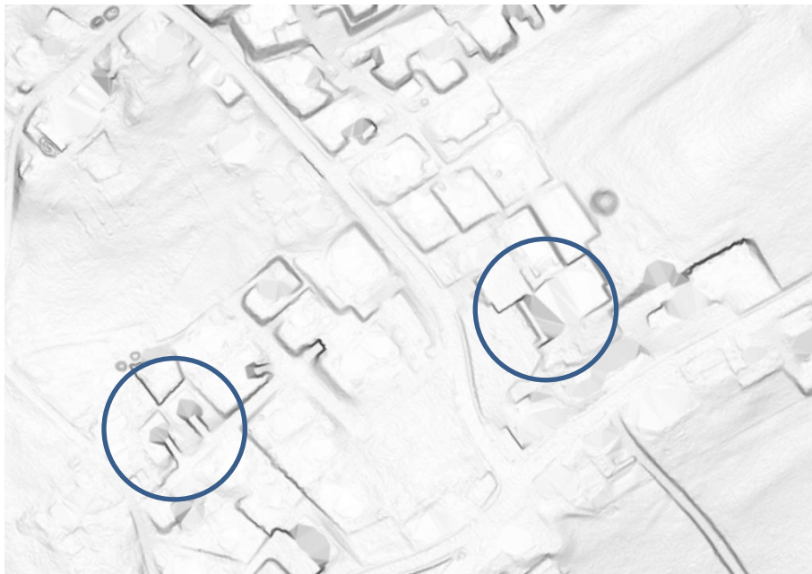
Abbildung 14: DTM im Bereich von Gebäuden
