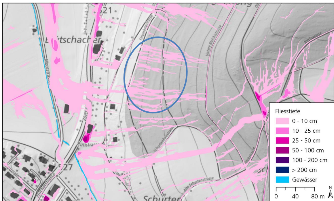
Abbildung 21: Oberflächenabfluss im Wald für ein Ausschnitt bei Hedingen. Auf der Hinweiskarte Oberflächenabfluss ist im Wald teilweise flächiger Oberflächenabfluss ausgeschieden (blau umkreist), da aufgrund der Rauigkeit das Oberflächenwasser langsamer fliesst als z.B. auf Landwirtschaftsflächen (Quelle Kartenhintergrund: Landeskarten und Hillshade, Bundesamt für Landestopografie).
