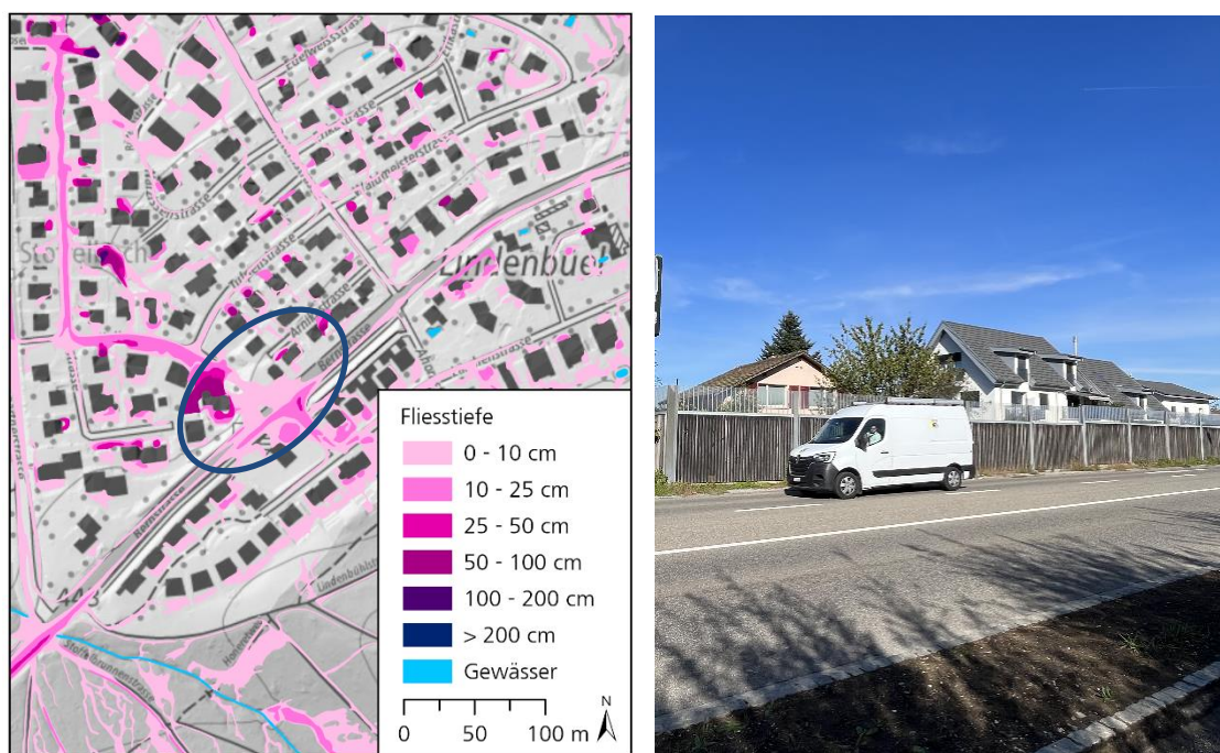
Abbildung 16: Nicht erfasste Kleinstrukturen wie hier eine Lärmschutzmauer in Dietikon (rechts), führen zu Fliesswegen im Modell, welche nicht mit der Realität übereinstimmen (links, blau umrandet) (Quelle Kartenhintergrund: Landeskarten und Hillshade, Bundesamt für Landestopografie; Quelle Foto: geo7 AG).
